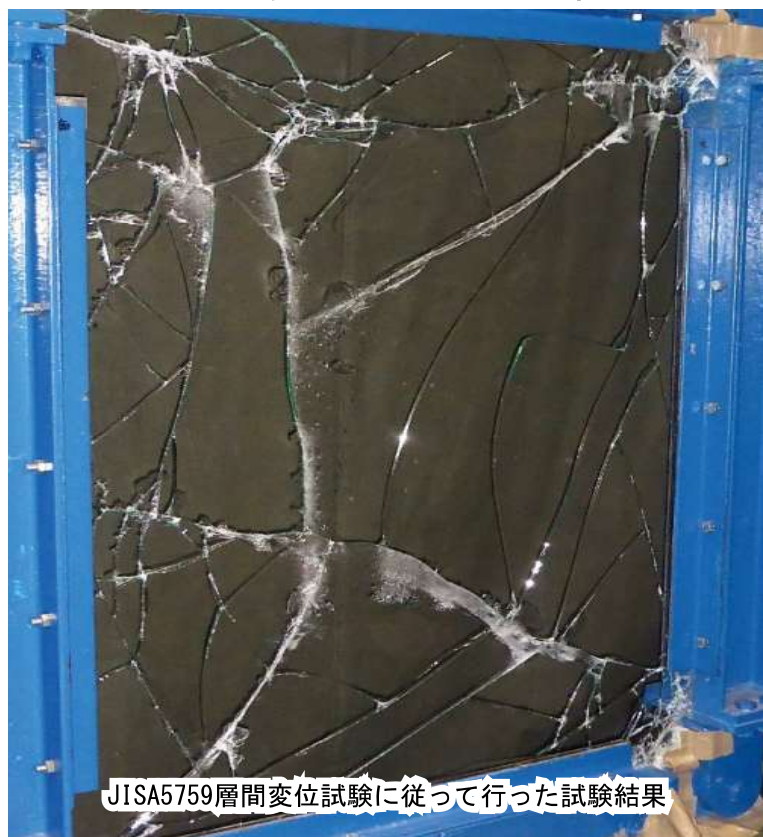
JISA5759ショットバック試験に従って行った試験結果
