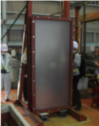
落下高さ: 450mm10回 破損: 無 加撃面側
